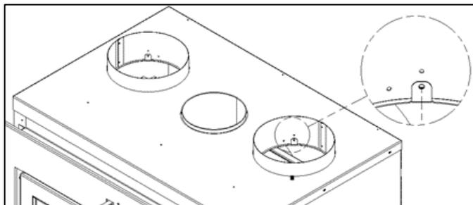
Illustration 3-20 : Installation des adaptateurs de conduit de 8 pouces
