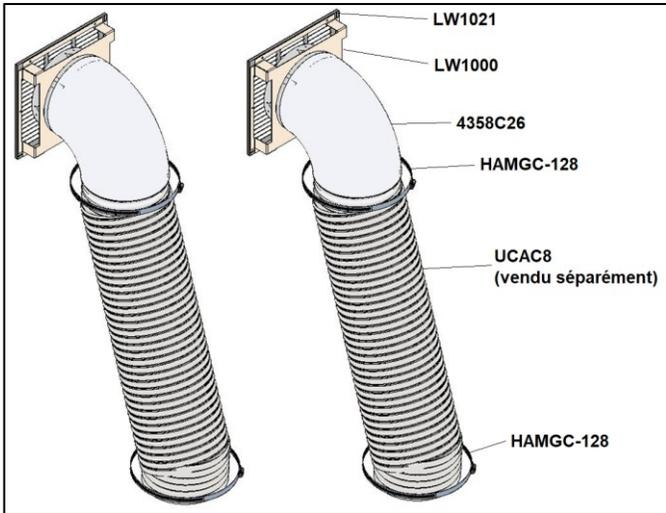
Illustration 3-21 : Schéma d'assemblage de l'ensemble KG540
