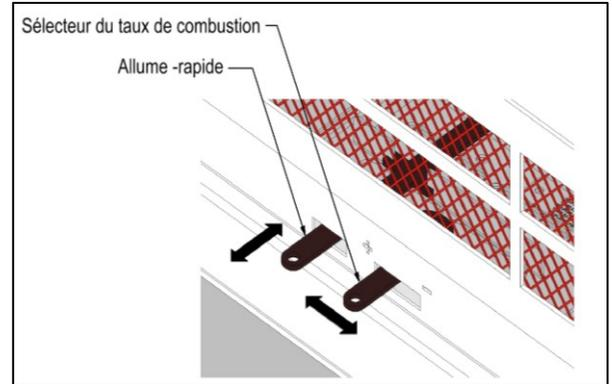
Illustration 2-3 : Contrôle de l'air de combustion
