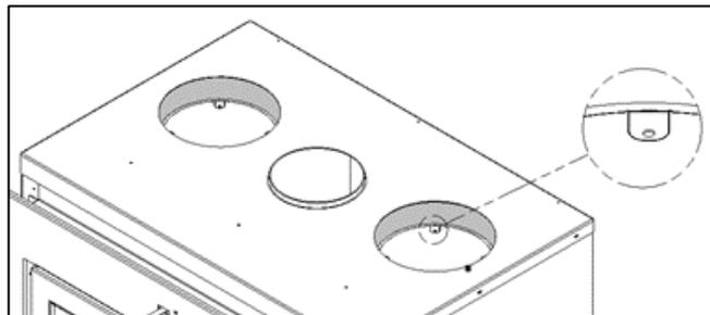
Illustration 3-19 : Languettes à l'intérieur des ouvertures de 8 pouces
