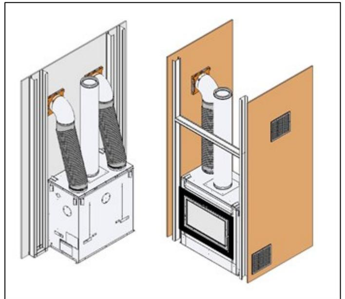
Illustration 3-22 : Installation des sorties d'air chaud par gravité
